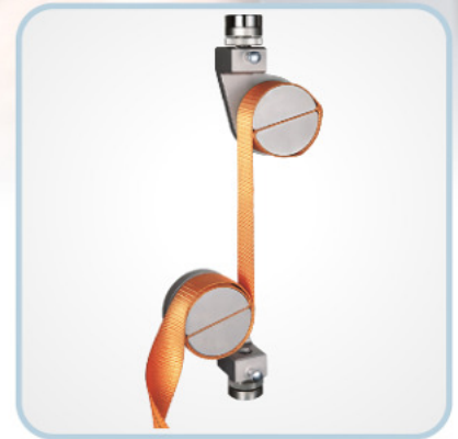
Webbing Tensile Test
